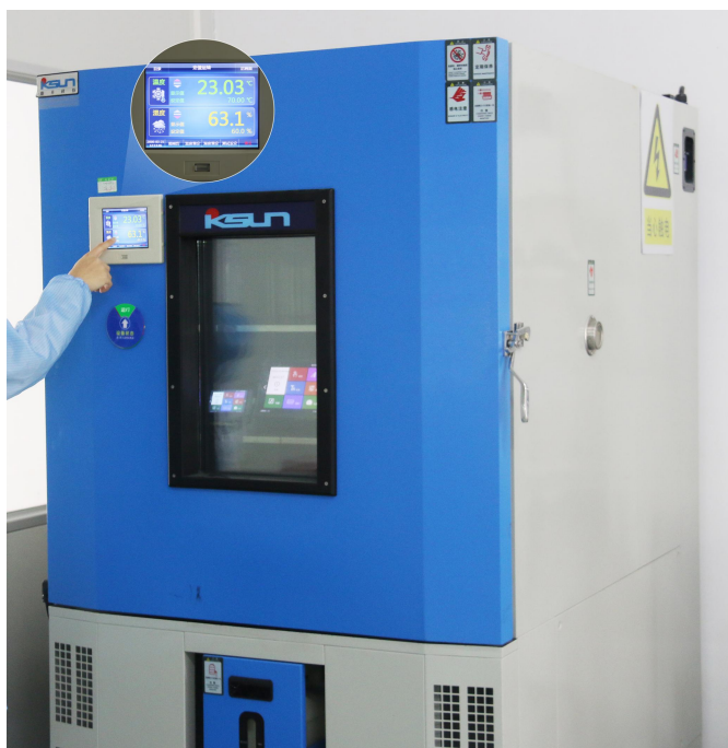
图 4-7 高低温老化测试图
